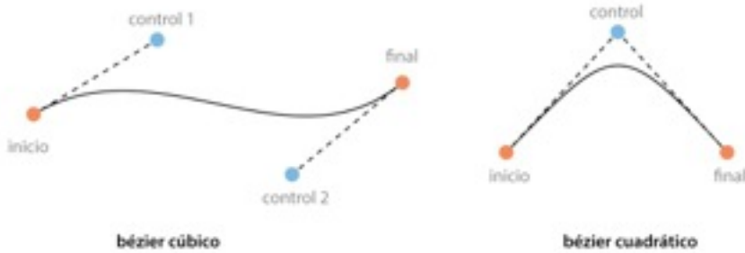
figura 1. Curvas que se pueden dibujar con la clase UIBezierPath 8
